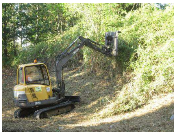
Figura 31 - Limpeza de matos mecânica: corta-matos
