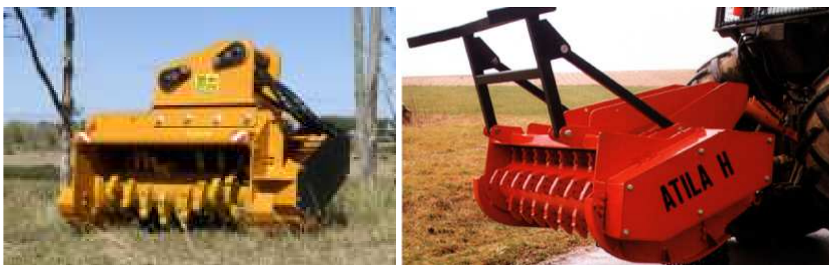
Figura 32 - Limpeza de matos mecânica: destroçadores
