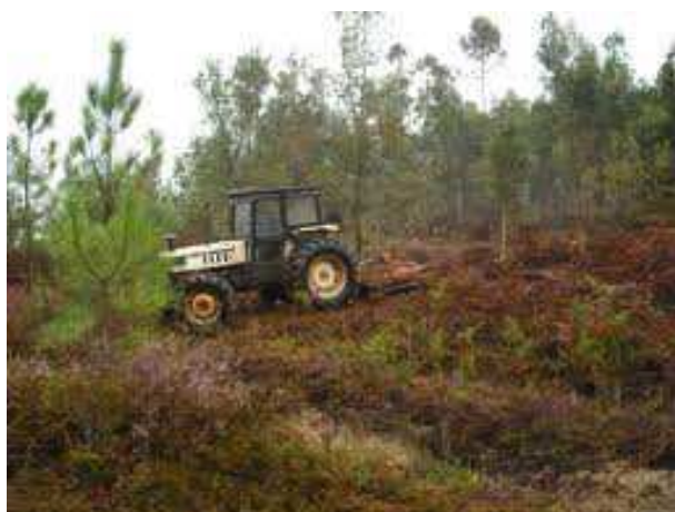
Figura 31 - Limpeza de matos mecânica: corta-matos
