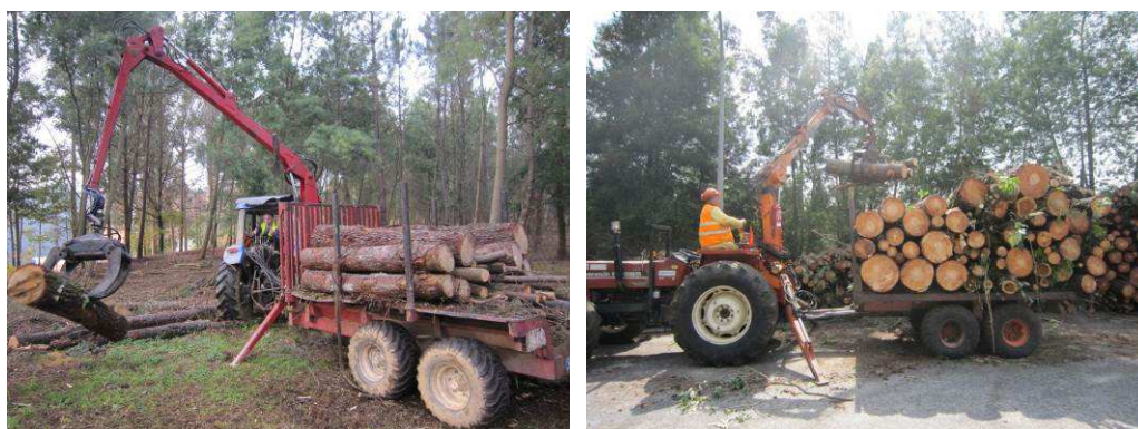
Figura 23 - Transporte da madeira para carregadouro e empilhamento
